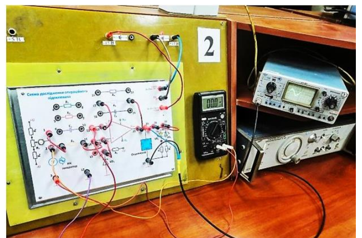
Стенд для дослідження операційного підсилювача та схем його включення
