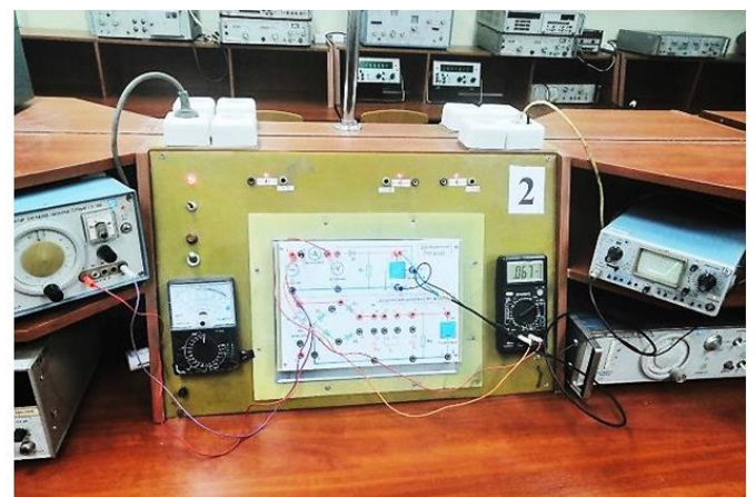
Стенд для дослідження вольт-амперної характеристики напівпровідникового діода
