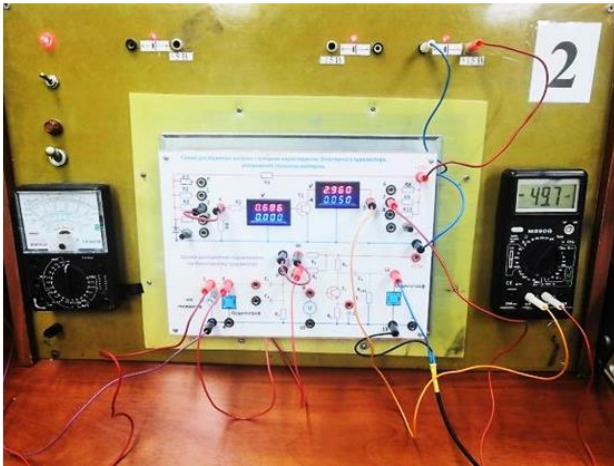
Стенд для дослідження підсилювача на біполярному транзисторі
