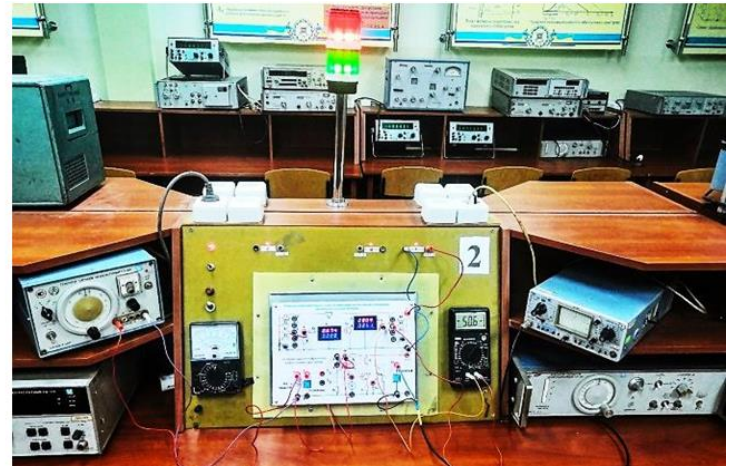
Стенд для дослідження підсилювача на біполярному транзисторі
