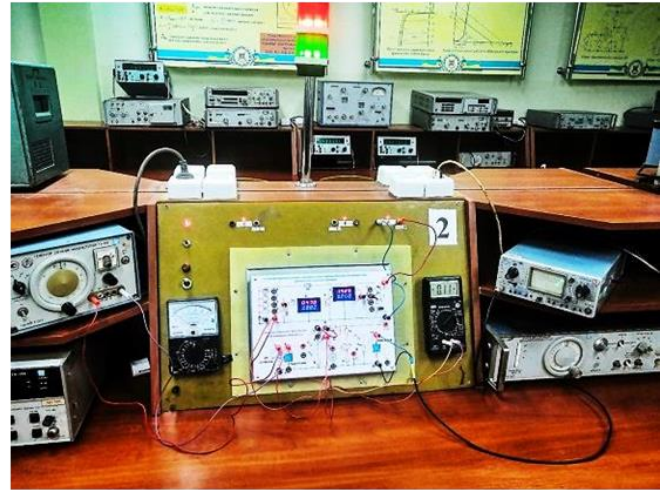
Стенд для дослідження характеристик біполярного транзистора
